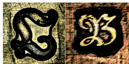
2D-Bilder von stark reflektierenden Matrizen aus Messing oder Kupfer
